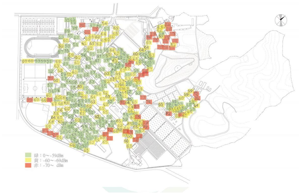
図 1 吉田キャンパスにおける無線 AP 設置場所と電波強度
