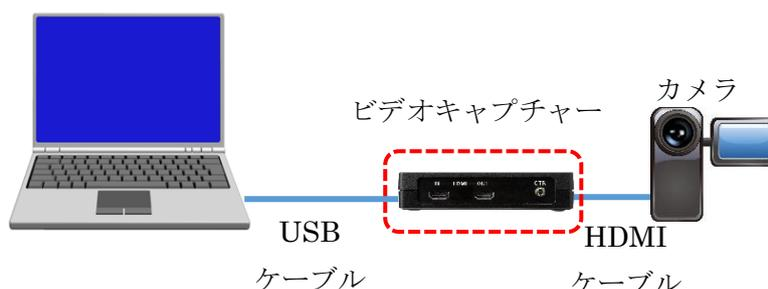
図 16 デジタルビデオカメラの接続例
